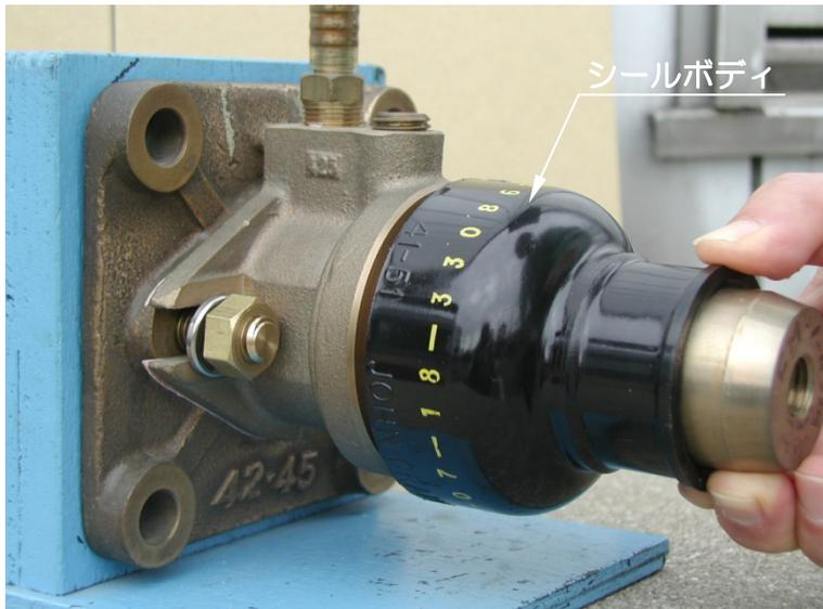
プロペラ軸の前端からシールボディを挿入する。
