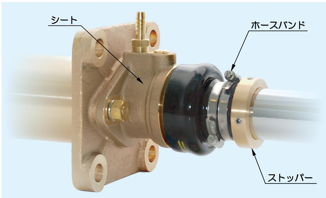
シールボディをシート方向に規定量（10 mm）押し付け、その状態でホースバンドにて軸に固定する。大径サイズについてはストッパーでさらに固定する。
