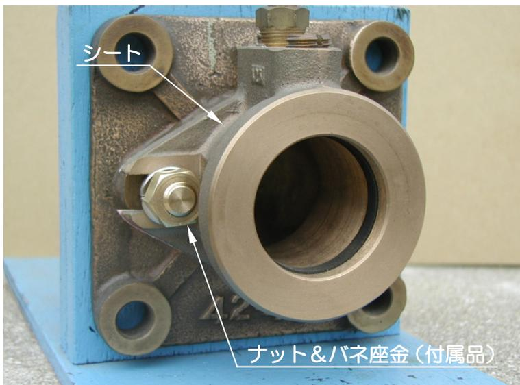
シートを取り付け、バネ座金を入れてナットで固定する。
