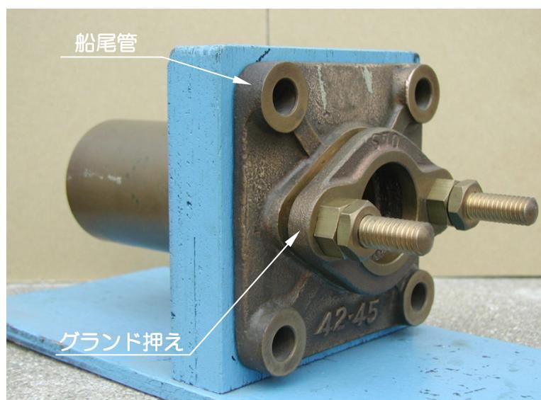
NEL シールは国内主要メーカー製の船尾管に取り付け可能な寸法を標準寸法としている。
